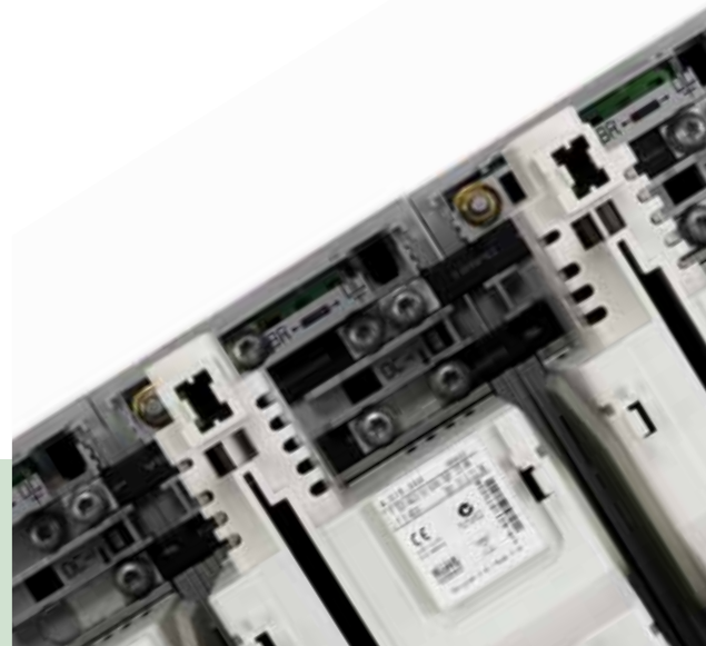
Konfiguracja wspólnej szyny DC umożliwia powtórne wykorzystanie energii hamowania w systemie napędowym
