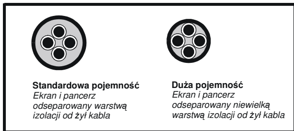
Rysunek 4-6 Wpływ budowy kabla na jego pojemność
