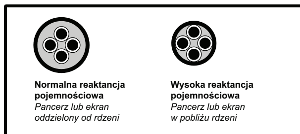
Rysunek 4-17 Wpływ konstrukcji kabla na reaktancję pojemnościową
