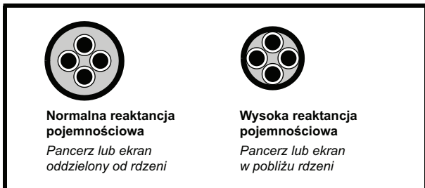
Rysunek 4-15 Wpływ konstrukcji kabla na reaktancję pojemnościową
