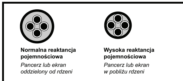
Rysunek 4-13 Wpływ konstrukcji kabla na reaktancję pojemnościową
