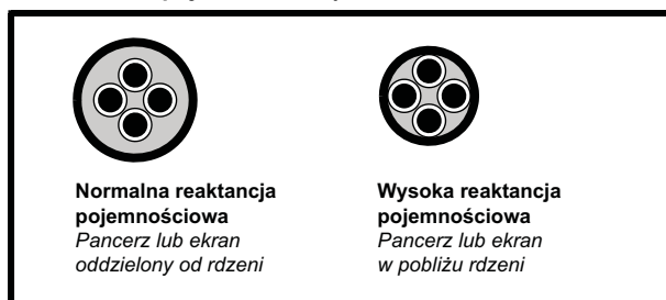
Rysunek 4-6 Wpływ konstrukcji kabla na reaktancję pojemnościową
